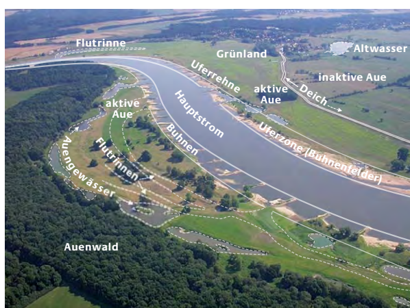
Das System aus Hauptstrom, flussbaulichen Regelwerken und angrenzender Aue ist Gegenstand der Betrachtung (Foto: BFG)
